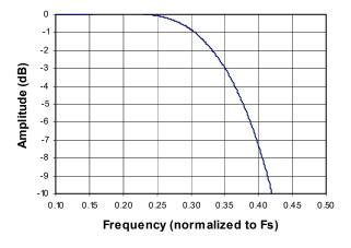
Figure 27. Quad-Speed Transition Band (Detail)
