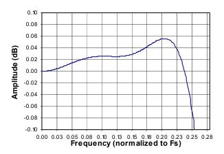
Figure 28. Quad-Speed Passband Ripple
