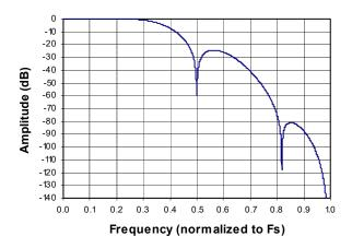
Figure 25. Quad-Speed Stopband Rejection
