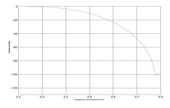
Figure 10. Quad-Speed Mode Transition Band
